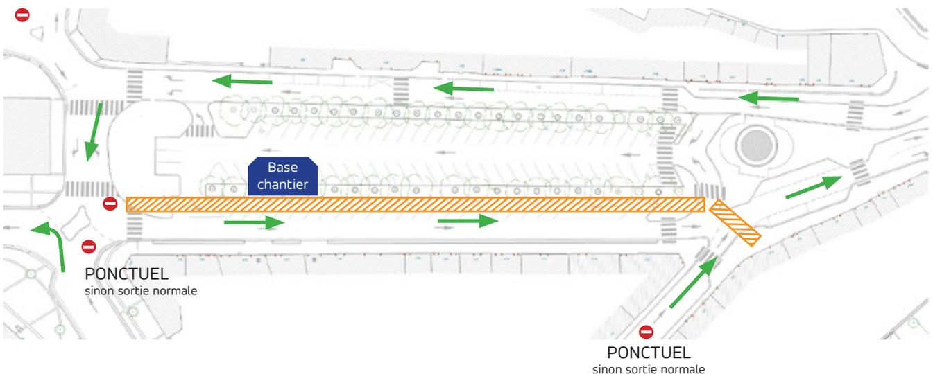
**Du 14 au 25 mai** : fouille et pose des fourreaux pour le réseau électrique, allée Valentin-Hauy, depuis le poste existant jusqu'à la sortie du porche rue Saint-Luc et finalisation des travaux d'eau potable (branchement).
